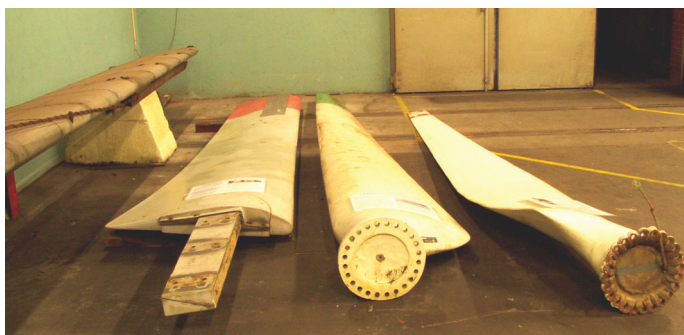
Historiske møllevinger på udstillingen i Lem. Længst til højre en 4,5 m Øker-vinge fra en Adolphsen-mølle, i midten en 5 m Øker/Alternergy vinge fra en Bonus 30 kW og til venstre en tidlig Riisager-vinge fra LM Glasfiber. Langs væggen ses en vinge fra den sidste bevarede FLS Aeromotor i Ullerslev - fremstillet af Lykkegaard på Fyn.
